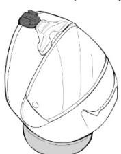
8. L'adesivo deve indurire per almeno **48 ore**. Tuttavia, si consiglia di lasciar polimerizzare l'adesivo per 72 ore e di riporlo su un tappetino per caschi in modo che l'adesivo possa indurirsi, la sezione del mento punta verso l'alto.
