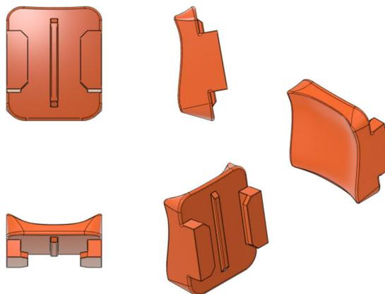
Nachdem das Modellieren abgeschlossen ist, drucke ich einen Prototyp der an den Abdruck angehalten werden kann. Hiervon gibt es bei Bedarf auch Fotos.
